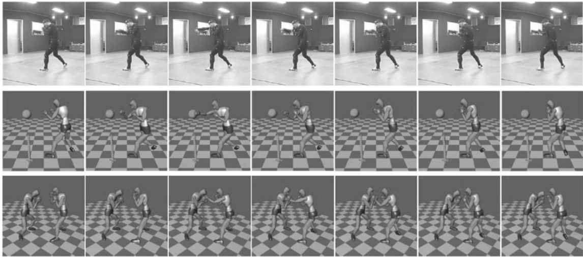
그림 5 강화 학습을 이용한 가상 권투 선수 동작 제어([6]에서 그림 발췌). (상단) 실제 권투 선수의 모션 캡처. (중단) 강화 학습을 이용해서 가상 권투 선수가 움직이는 목표를 추적하고 가격할 수 있도록 학습. (하단) 두 명의 가상 권투 선수가 학습된 행위 모델을 이용하여 가상의 권투 경기
