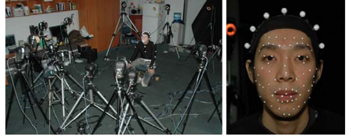
[그림 7] (좌측) 바이콘 광학 시스템을 이용하여 얼굴 캡처를 하는 장면이다. (우측) 얼굴 전면에 68개의 마커를 머리위에 7개의 마커를 붙여서 얼굴의 움직임을 캡처한다.
